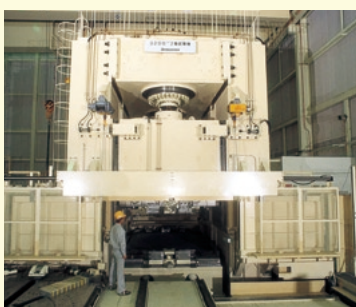
鉛直方向に32MN(3,200トン)もの力をかけることができる特殊な2軸試験機で、超高層建物などに用いられる大型免震ゴムの検査に対応
