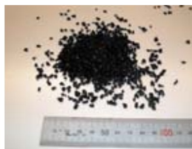
ゴムチップ 使用ゴムチップ：トラックバス用の大型タイヤを破碎して得られる2～5mmのゴムチップ
