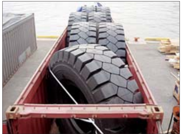
建設車両用タイヤの積み込みで、スペースの効率化を進めている事例
