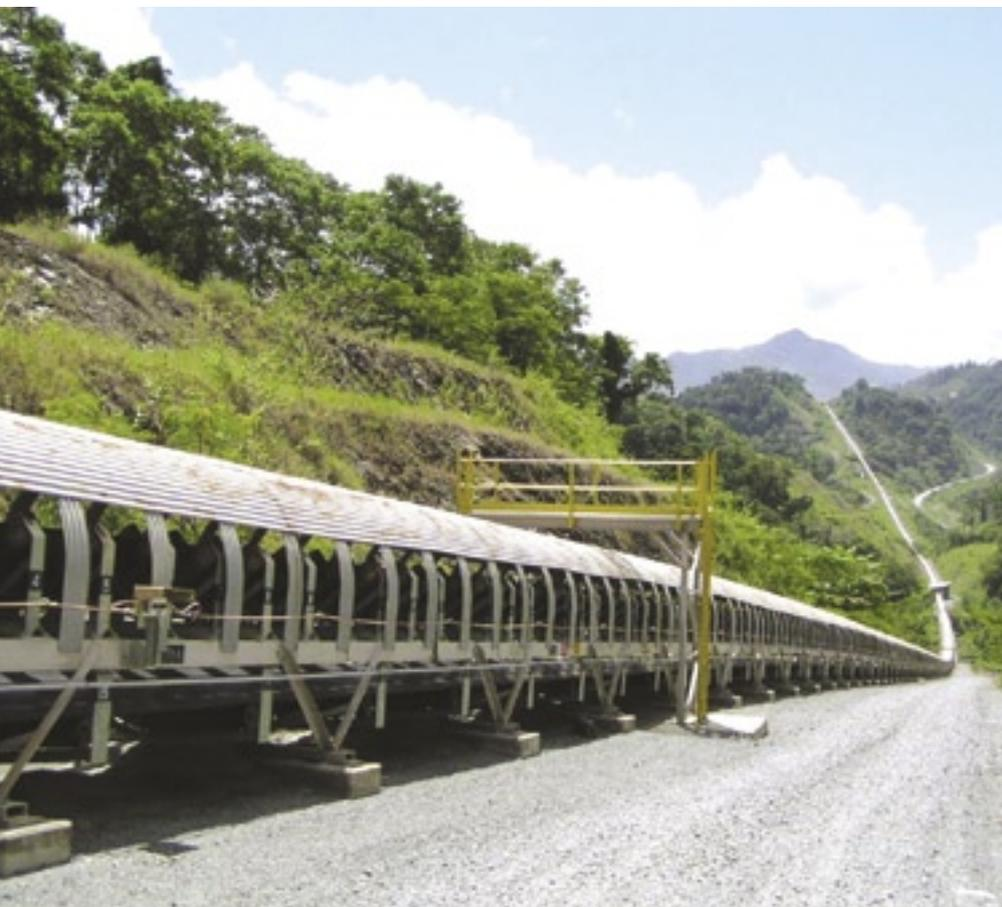
コンベアラインの操業においては、想像以上のエネルギーを消費しますが、コンベアラインの消費電力を大幅に削減できる省エネベルト「BEATRON」を開発しました。ベルトがローラー上を通過する際に発生する乗り越え抵抗に着目し、ゴム粘弾性特性の最適化設計を施し、さらに独自のHELLO理論(ベルト最適設計理論)を融合させ、従来のゴムベルトに対し、乗り越え抵抗を従来比50%半減することに成功しました。実際の長距離コンベアラインに適用した結果では、約30%の電力を削減できることを実証しています。「地球環境保護に貢献する」という新しい開発コンセプトの下に生まれた先進のベルトです。
