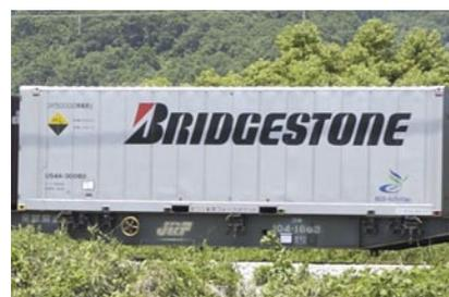
コンテナの製作にあたっては、容積勝ち<sup>※2</sup>のタイヤやチューブなどを少しでも多く積むことを優先事項とし、容積確保に主眼を置いて設計しました。コンテナは妻開きで、製品を保護するためカラーボードを内面に張り巡らせ、ラッシングフックを側面に設置し、環境にもタイヤにも配慮したコンテナを目指しました。また、コンテナの側面には、ブリヂストンの環境活動を表すシンボルマークが入っています。
